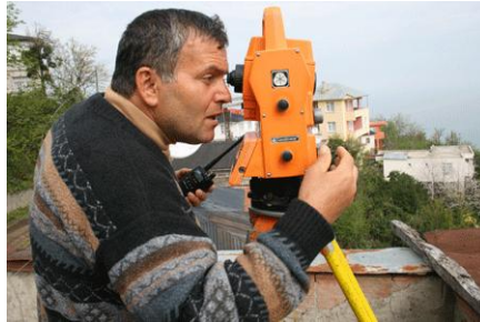
Resim 3.1: Parsel sınırının ölçümü
