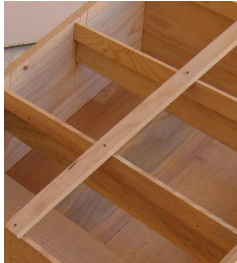
Resim 2.10: Alın tahtalarının çita ile desteklenmesi
