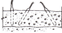
Resim 1.9: Homojen sıkıştırma sağlanamayacağı için yanlış vibrasyon
