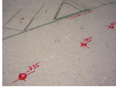
Resim 1.14: Arazinin topoğrafik durumunun ölçülerine ve maket ölçeğine göre işlenmesi
