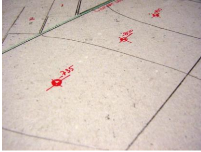
Resim 1.14: Arazinin topoğrafik durumunun ölçülerine ve maket ölçeğine göre işlenmesi
