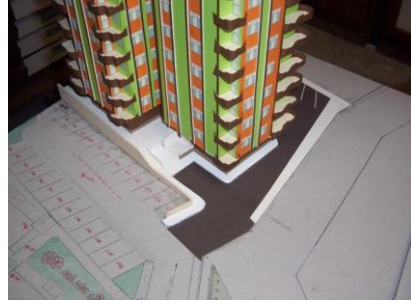
Resim 1.21: Maketin altlğa monte edilmesi
