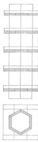
Şekil 20: Ahşap, kare, altıgen ve daire kesitli kolon kalıpları
