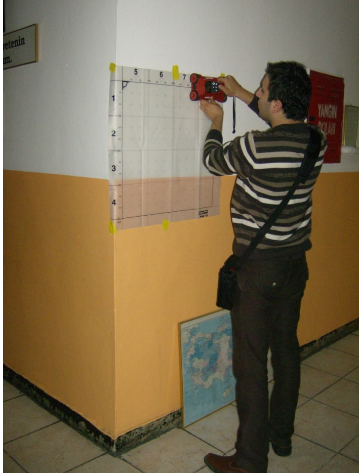
Tahribatsız yöntem: Ferroskan cihazı ile betonarme duvar yüzeyinde tarama yapılması ve tarama sonucu
