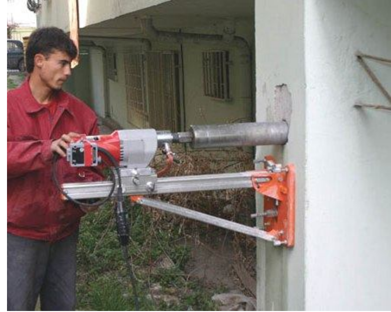
Karot alma cihazı ile kolondan silindir beton örneđi alınması
