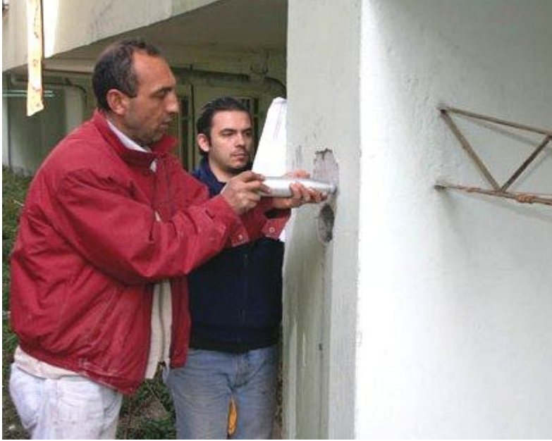
Schmidt darbe çekici ile yüzey sertliđi değeriinin okunması
